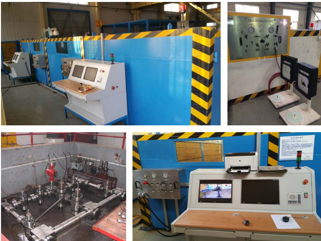
管汇水压测试
